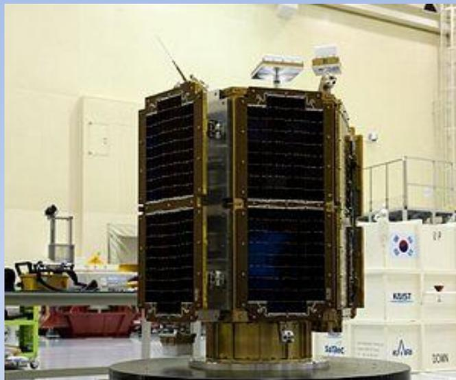
STSAT-2C — южнокорейский спутник, запущенный в 2013 г. Им управляет Корейский институт аэрокосмических разработок, спутник предназначен для демонстрации технологий будущих космических аппаратов. Спутник имеет массу 100 кг, запланированное время работы — менее года.
